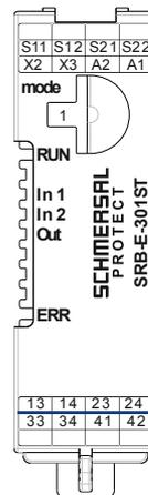
Die Sicherheitskontakte 13-14 und 23-24 erfüllen gegen alle anderen Anschlussklemmen, ohne zusätzliche Maßnahmen, die Anforderungen für doppelte Isolierung gemäß EN 60664-1 und sind bei Schaltspannungen > 50 V zu verwenden. Die Sicherheitskontakte 33-34 erfüllen die Anforderungen für Basisisolierung.
