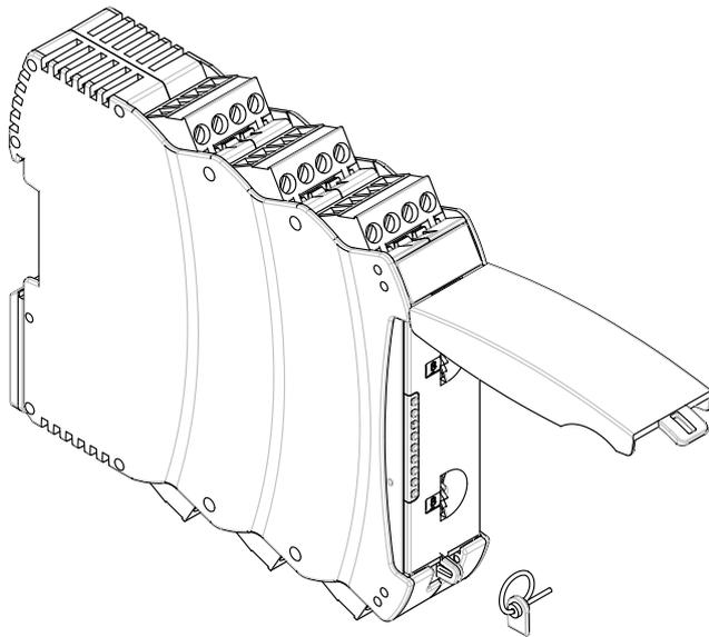
**Ajuste de la aplicación con el interruptor giratorio "mode"**
