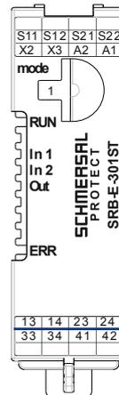
Los contactos de seguridad 13-14 y 23-24 cumplen, respecto a todos los demás bornes de conexión, sin medidas adicionales, las exigencias para el doble aislamiento según la norma EN 60664-1 y deberán utilizarse con tensiones de conmutación > 50 V. Los contactos de seguridad 33-34 cumple con las exigencias del aislamiento básico.
