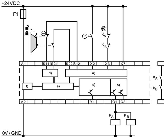
**Ejemplo de conexión SRB-E-301ST**
