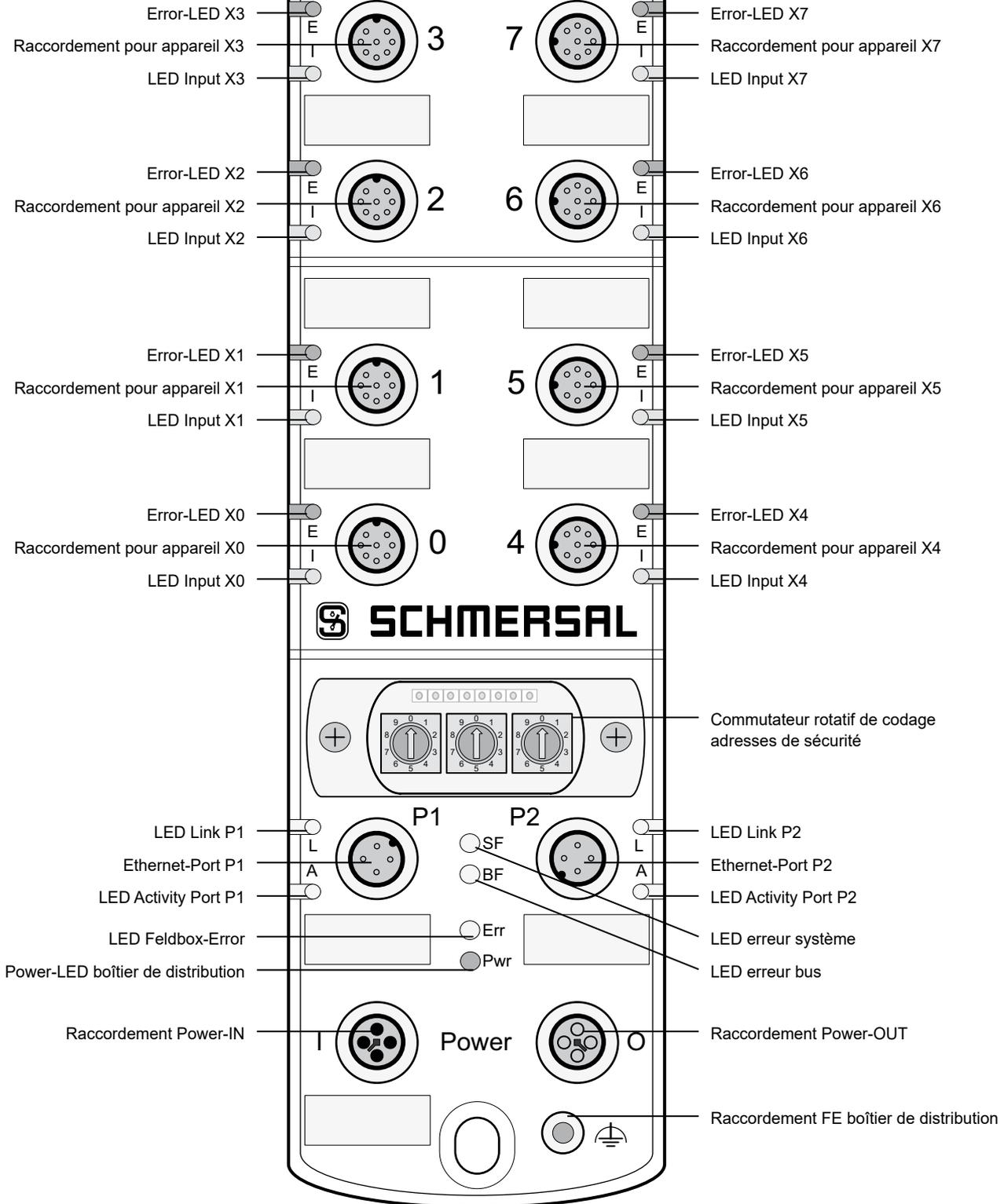
**4.6 Configuration du connecteur raccords appareils X0 – X7**
