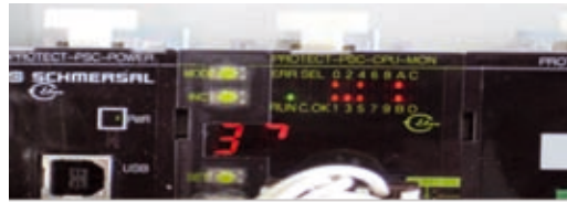
Abb. 9: Klare Anzeige auf CPU-Modul, welche Ein- und Ausgangssignale anliegen
