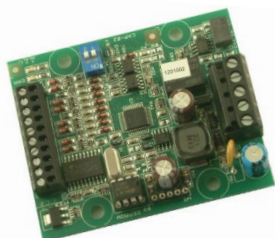
Abbildung 15: Platine CAP-02 zum Anschluss der Außenrufe an den CANopen Lift-Bus
