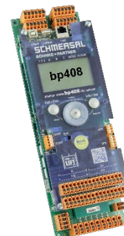
Abbildung 74: Das Steuerungssystem bp408 ist ein sehr wartungsfreundliches System. Es kann Sie automatisch beim Bedarf einer Wartung informieren
