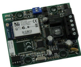
Abbildung 17: Platine CWI-01 zur Fernbedienung der Steuerung (z.B. von der Kabine aus) über ein mobiles Gerät (Handy, Tablet, Notebook).
