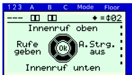
Abbildung 29: Das Rufmenü des bp408 wird durch eine Raute in der Liftstatusleiste signalisiert
