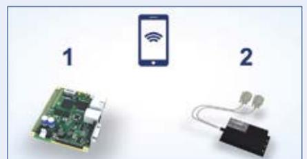
La transmisión de valores medidos, datos de posición, informes de averías y otros datos útiles del ascensor a la nube requiere un equipo técnico mínimo. equipo técnico. Además de nuestro controlador, que recoge todas las lecturas y datos, se necesita una pasarela para convertir la información a un formato compatible con la nube. Una segunda función muy importante de la pasarela es conectar el controlador a Internet mediante una conexión segura.
