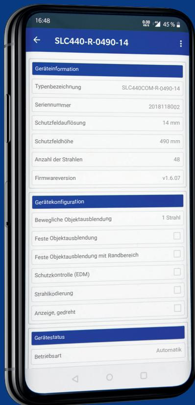
Mit Bluetooth® LE steht eine innovative Kommunikations-Schnittstelle für die Diagnose und Inspektion von berührungslos wirkenden Schutzeinrichtungen (BWS) zur Verfügung.
