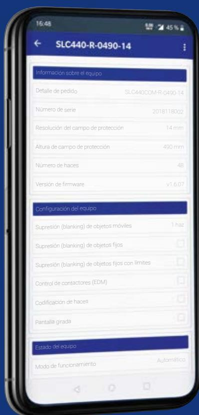
Con Bluetooth® LE se dispone de una innovadora interface para el diagnóstico e inspección de dispositivos de seguridad que funcionan sin contacto (AOPD).
