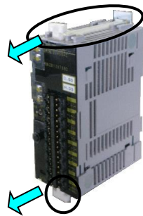
Abbildung 4-2 Montage eines Moduls (1/3)
