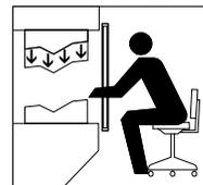
Sólo se puede acceder a partes peligrosas de la máquina pasando por el campo de protección.
