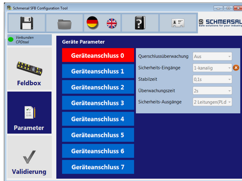
Abbildung 16: Parameter Sicherheits-Eingänge entspricht nicht den Abhängigkeiten
