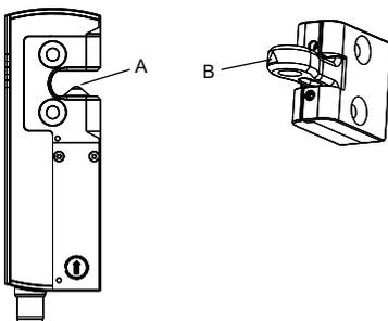
Zur Befestigung der Sicherheitszuhaltung und des Betätigers sind je zwei Befestigungsbohrungen (Senkbohrungen (Standard) oder planes Gehäuse (Ausführung -PH)) für M5-Schrauben vorhanden.
