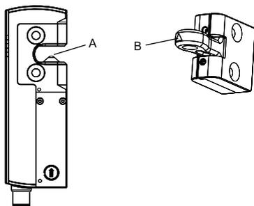
Para a fixação do solenoide de segurança e do atuador existem dois furos de fixação (furos escareados (standard) ou caixa plana (versão -PH)) para parafusos M5.
