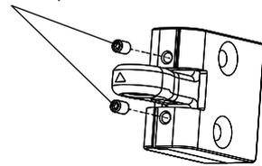
Os parafusos sextavados interiores não podem ser completamente desenroscados.
