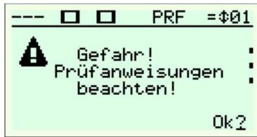
Der Warnhinweis im Display der Steuerung „Gefahr! Prüfanweisungen beachten!“ erscheint nach der Aktivierung des Prüfmodus.
