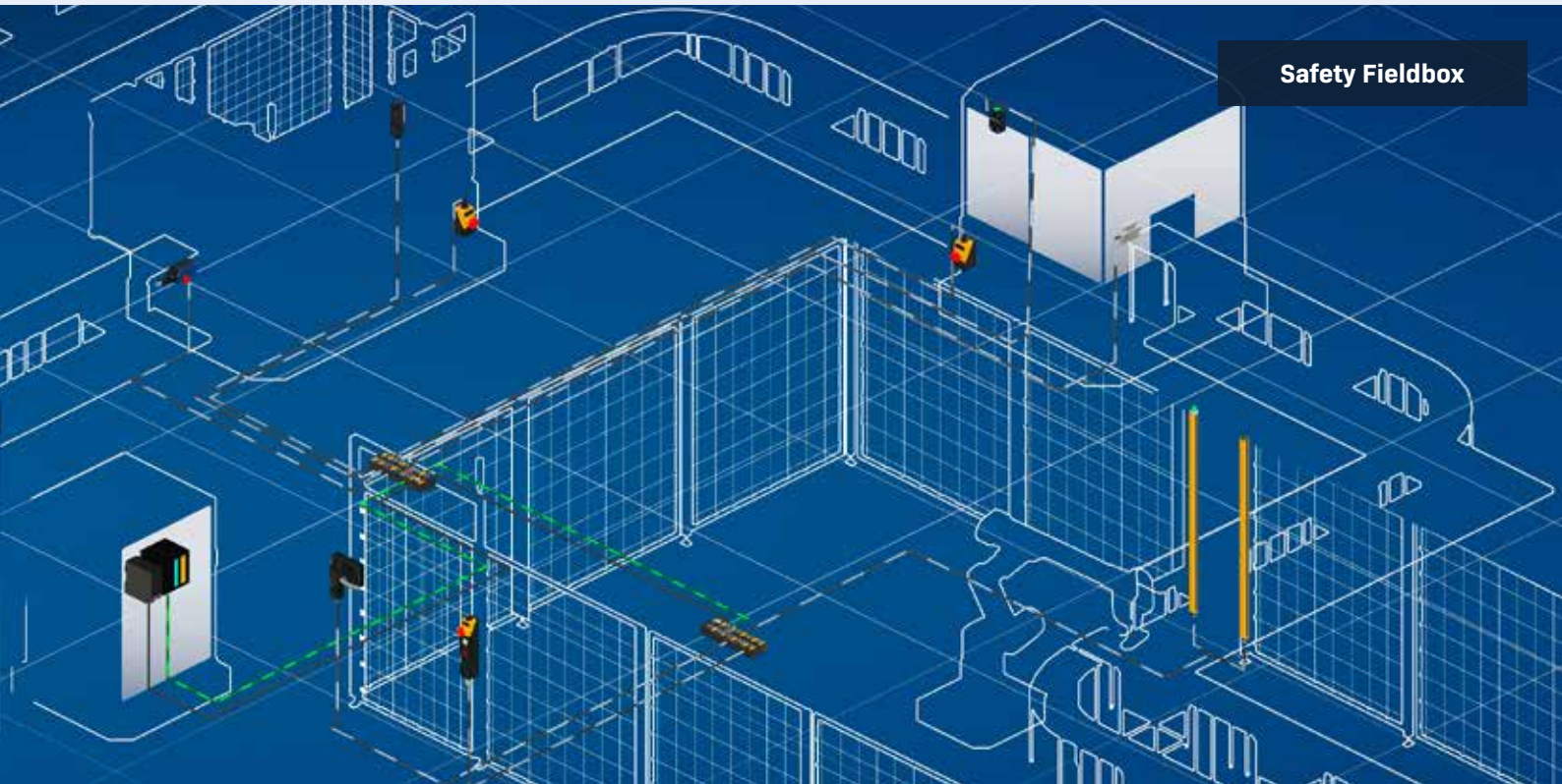
Abbildung 2: Anlage mit Verdrahtung in Sternschaltung
