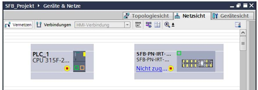
**Schritt 3: SFB-PN im PROFINET-Netzwerk konfigurieren (IP-Adresse & PROFINET-Name)**
