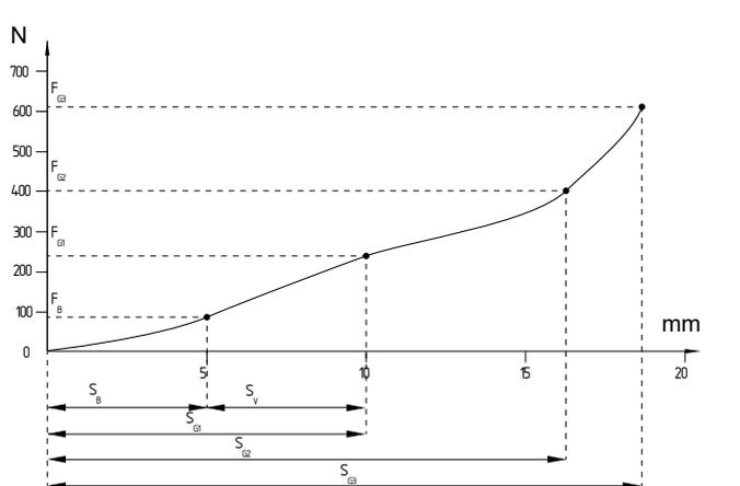
Fig. 2: Diagrama de forças-trajetos do perfil STW-SL-N-06
