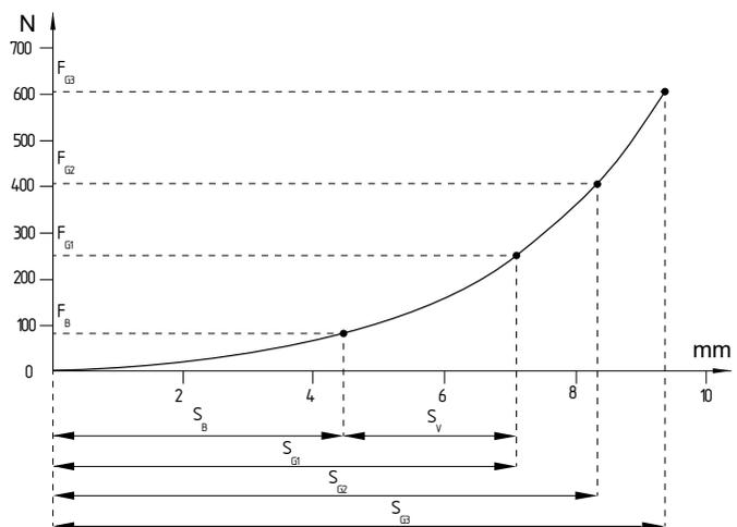
Fig. 1: Diagrama de forças-trajetos do perfil STW-SL-N-05
