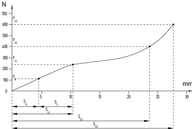
Fig. 3: Diagrama de forças-trajetos do perfil STW-SL-N-08
