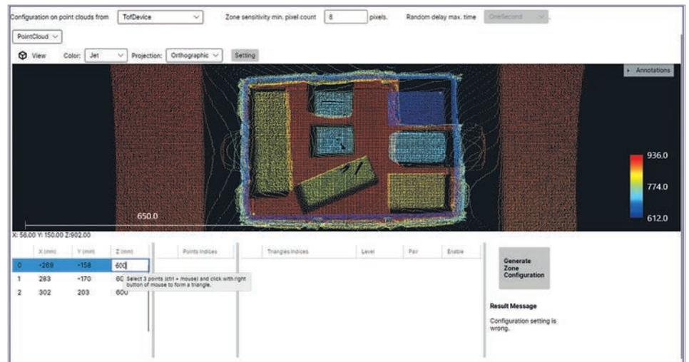
Die Werte können durch Anklicken des Wertefeldes (X, Y, Z) angepasst werden. So können beispielsweise mehrere Punkte auf derselben Höhe erzeugt werden.
