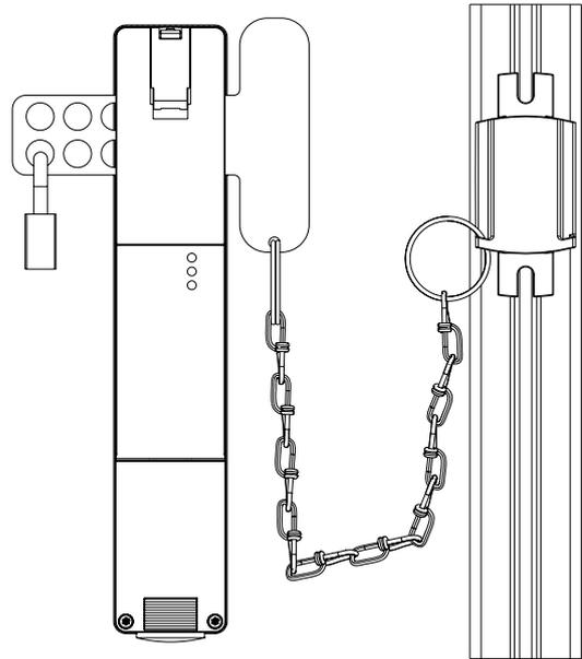
**Utilizzo di SZ201-1 con elettroserratura di sicurezza AZM300**
