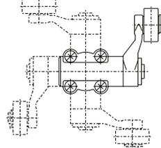
Der Betätigungsvorsatz lässt sich um  $4 \times 90^\circ$  versetzen. Svitare le quattro viti di fissaggio (profilo a croce PZ2), spostare il castelletto nella posizione desiderata e serrare nuovamente le quattro viti (coppia di serraggio 1,5 Nm).
