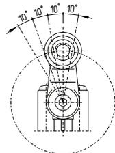
La leva oscillante può essere ruotata sull'albero scanalato complessivamente di  $360^\circ$ , in incrementi di  $10^\circ$ . Svitare la vite a testa esagonale per 4 mm circa, spostare la leva nella posizione desiderata e serrare nuovamente la vite.
