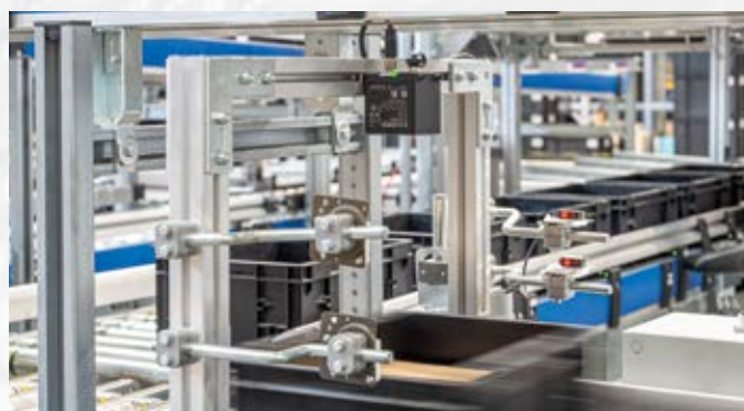
Détection rapide du niveau de remplissage
