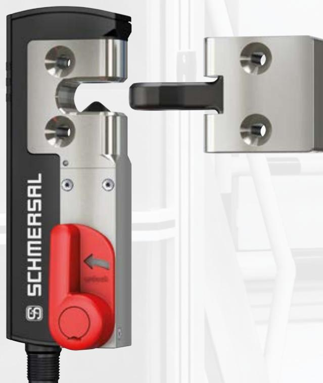
L'AZM40 adopte le principe de fonctionnement bistable qui maintient son dernier état de verrouillage en cas de panne de courant. Le protecteur reste interverrouillé lors des mouvements inertiels dangereux.
