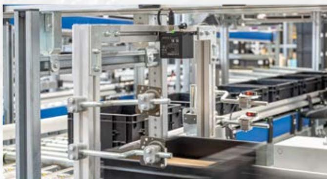
Détection rapide du niveau de remplissage
