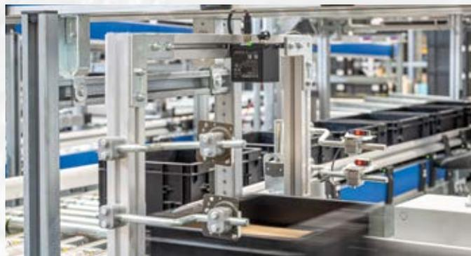
Deteção rápida do nível de enchimento
