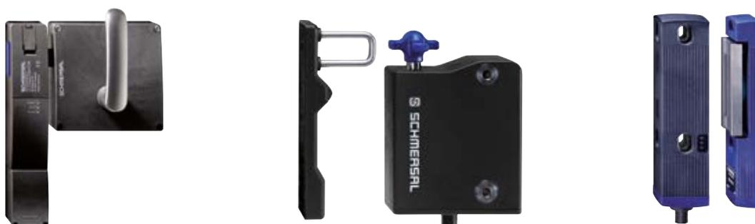
Sicherheitszuhaltungen gewährleisten, dass drehbare, seitlich verschiebbare und abnehmbare Schutzeinrichtungen wie Hauben, Gitter oder Türen nur dann geöffnet werden können, wenn kein gefahrbringender Zustand mehr besteht. Hierzu zählen beispielsweise Nachlaufbewegungen von Ketten, Walzen oder Wellen. Dabei wirken die Zuhaltungen zusammen mit Sicherheitsrelaisbausteinen sowie mit sicheren Stillstands-
