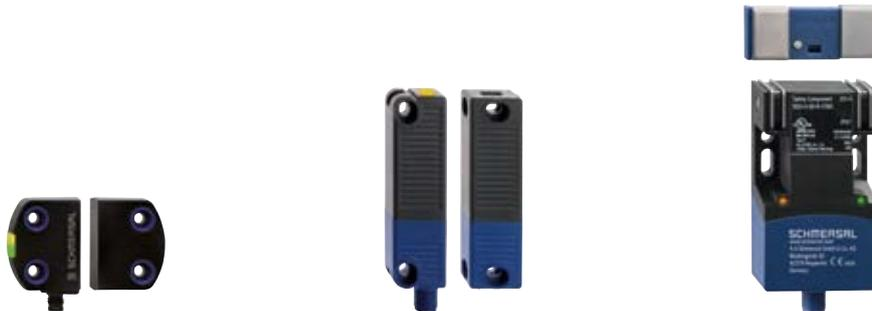
Los sensores de seguridad permiten detectar sin contacto la posición de las puertas protectoras. Esto resulta especialmente ventajoso en máquinas expuestas a un alto nivel de polvo y suciedad, así como en zonas sensibles a la higiene, como la industria alimentaria. Los sensores electrónicos de seguridad constan de un sensor y un objetivo que se comunican entre sí sin tocarse.
