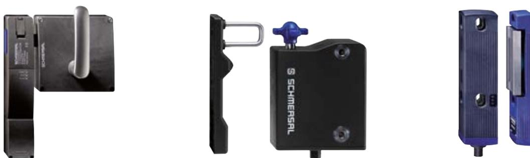
Los enclavamientos por solenoide garantizan que los resguardos abatibles, deslizantes lateralmente y desmontables, como capós, rejillas o puertas, sólo puedan abrirse cuando ya no exista una situación de peligro. Se trata, por ejemplo, de movimientos de sobrecarrera de cadenas, rodillos o ejes. El bloqueo funciona junto con módulos de relés de seguridad y monitores o temporizadores
