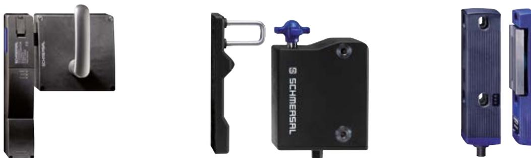
Les interverrouillages de sécurité garantissent que les dispositifs de protection pivotants, coulissants et amovibles tels que les capots, les grilles ou les portes ne peuvent être ouverts qu'en l'absence d'état dangereux. Il s'agit par exemple des mouvements de suivi des chaînes, des rouleaux ou des arbres. Les interverrouillages agissent alors conjointement avec des modules de relais de sécurité ainsi
