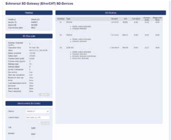
Abbildung 4: Detailansicht SD-Geräte Webserver
