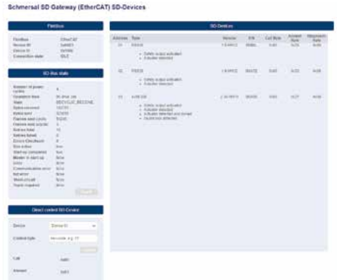
Figura 4: Detalle de los equipos SD servidor Web
