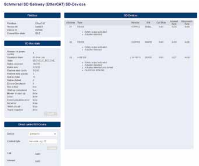
Ilustracja 4: Widok szczegółowy urządzeń SD serwera internetowego
