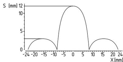
Der Querversatz (Y) beträgt max. ± 18 mm. Der max. Höhenversatz (X) beträgt ± 8 mm. Bei seitlicher Anfahrt den Bereich der Nebenkeulen meiden.
