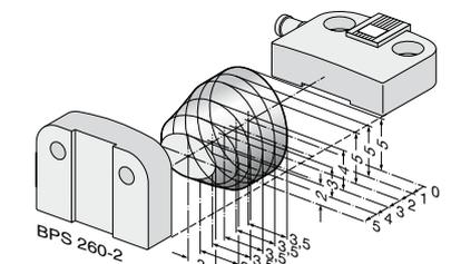
Distancia de conmutación asegurada:  $s_{ao} = 5 \text{ mm}$
