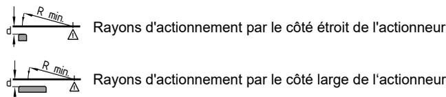
L'axe de rotation de la charnière et de la face supérieure de l'interrupteur de sécurité doivent se trouver dans le même plan distant de d [mm]. À la livraison, l'actionneur est pré-réglé pour des protecteurs avec le plus petit rayon R<sub>min</sub> [mm].
