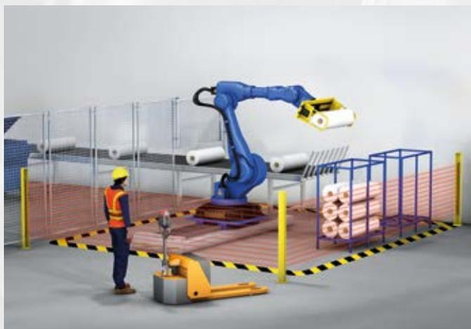
Les nouveaux rideaux lumineux de sécurité SLC440COM...H et les barrières immatérielles de sécurité SLG440COM...H offrent des portées étendues pour sécuriser de manière fiable les installations étendues, les lignes de convoyage ou les quais des métros autonomes.
