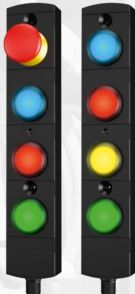
BDF40コントロールユニットはモダンでスリムなデザインが特徴です。緊急停止機能の有り/無しの2バージョンがあり、さらに照光式押しボタン及び、色付き押しボタンカバーに変更可能です。コントロールパネルはAZM40電磁ロック付きインターロック及び、接続接続カバー付きDHS-U1ドアハンドルのドアシステムに完璧に組み込むことができます。12極M12コネクターにより、迅速で間違いのない設置が可能です。
