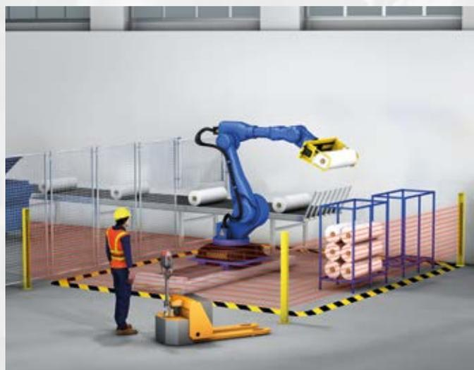
新しいSLC440COM...H セーフティライトカーテンとSLG440COM...H セーフティライトグリッドは、広範囲のシステム、コンベアのルート、地下に構築されたネットワークでの自動運転車両を操作するプラットフォームの確実な保護を提供するために、拡張された範囲を備えています。
