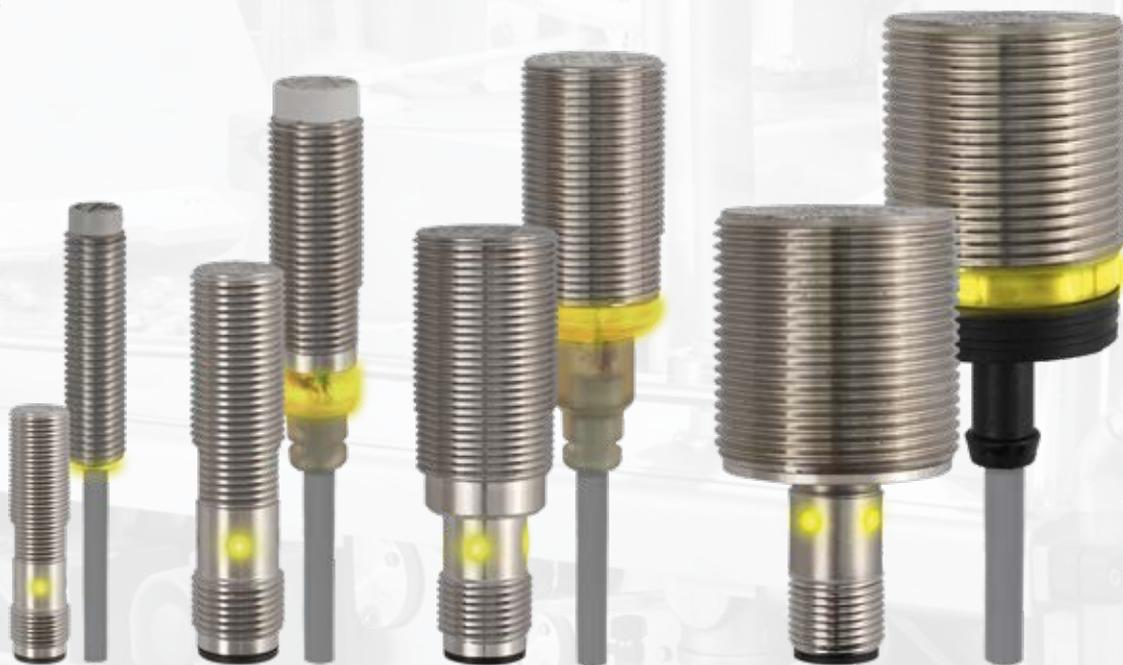
シュメアザールのIFL誘導型近接スイッチは、産業用途における位置検出と監視のための金属物体の非接触検出の標準ソリューションです。新しい近接スイッチは、NC（通常閉）およびNO（通常開）接点を持つ逆相出力機能を備えた4線式ソリューションにより最大限の柔軟性を提供し、内蔵のLEDインジケータは、物体が検出された時だけでなく、診断機能を備えており、短絡や過負荷を迅速かつ確実に示し
