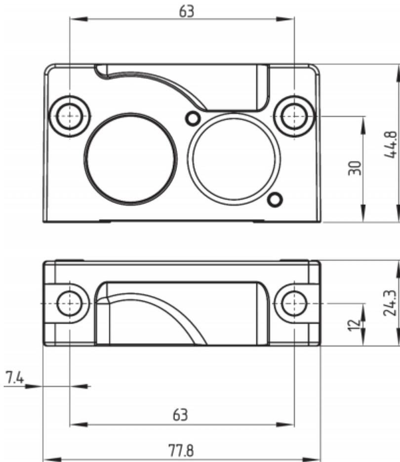
安装板，安装套件MS-AZM400
