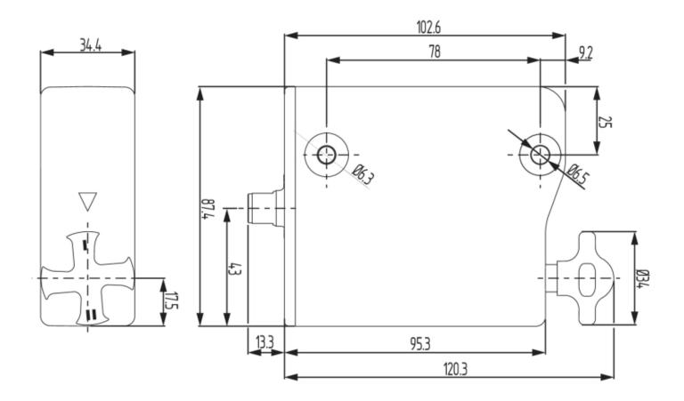
AZM300...-T/-T8 and -N 带紧急出口或紧急解锁的设备
