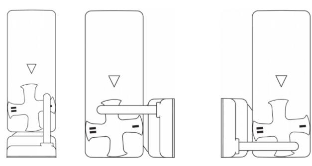
图示为封闭式防护系统、锁紧力设定为  $50 \ \mathrm{N}$  (另见 "锁紧力的调整"—章)。
