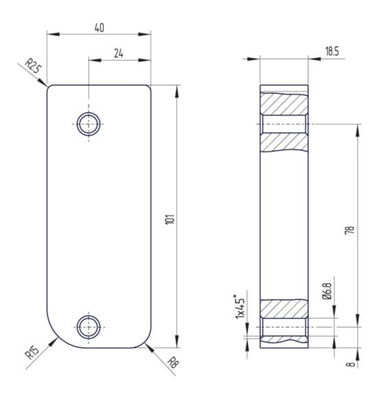
MS-AZ/AZM300-B1-1(可作为附件提供)作为盖板的铝质保护板,用于设计要求较高的机器上的玻璃门和塑料门
