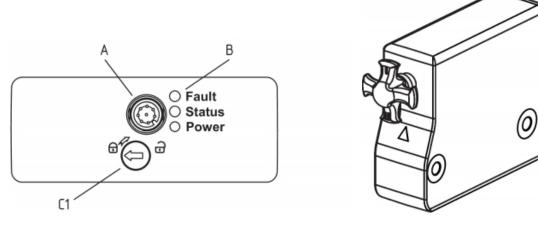
**注释**□ A: 连接器插头 M12,8针 B: LED显示屏0 C1:使用一字螺丝刀手动解锁0 C2:通过三角钥匙TK-M5手动解锁
