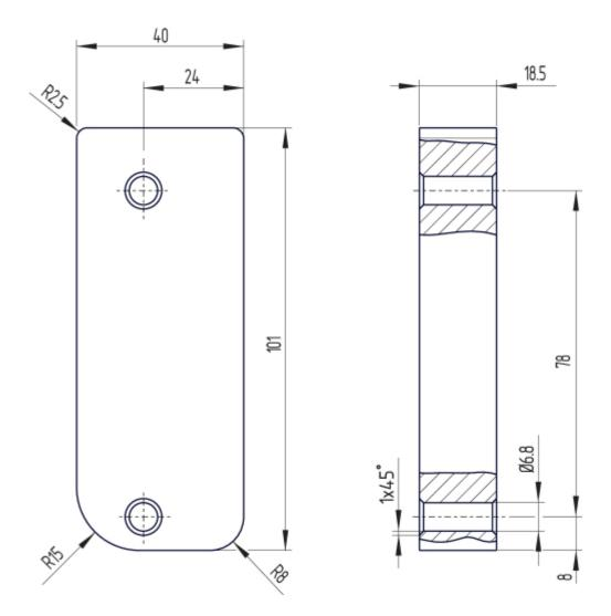
MS-AZ/AZM300-B1-1(可作为附件提供)作为盖板的铝质保护板,用于设计要求较高的机器上的玻璃门和塑料门
