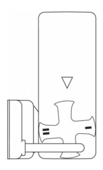
图示为封闭式防护系统、锁紧力设定为  $50\ N\ ($  另见 "锁紧力的调整 "一章) 。
