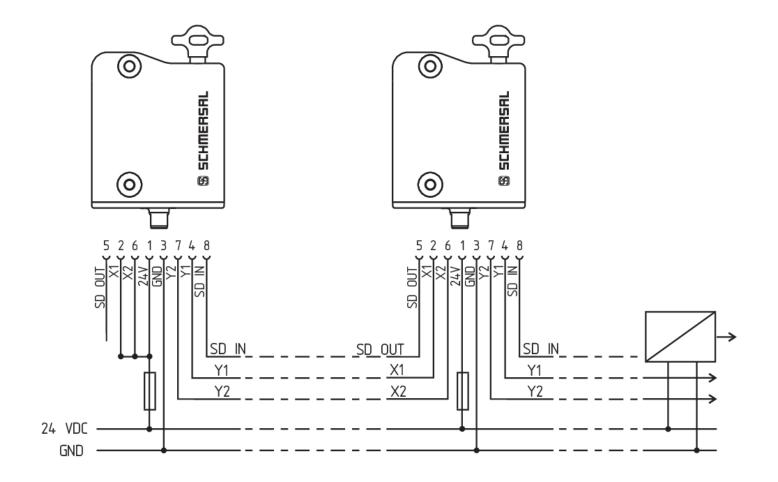
Y1和Y2 = 安全输出 → 安全监控模块 SD输入 → 网关 → 现场总线
