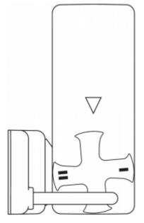
图示为封闭式防护系统,锁紧力设定为 50 N(另见"锁紧力的调整"一章)。
