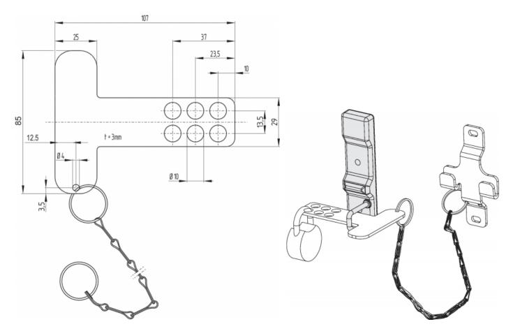
弓形电缆释放器 ACC-AZM300-BOW-.-.M-.M (可作为附件提供)请遵守弓形电缆释放器操作说明书中的附加说明。
