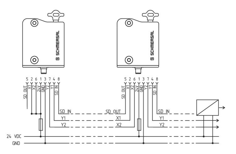
Y1和Y2 = 安全输出 → 安全监控模块 SD输入 → 网关 → 现场总线
